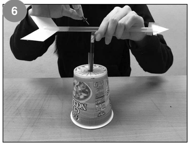
如指針未能保持平衡，嘗試改變圖釘在幼飲管上的位置。
